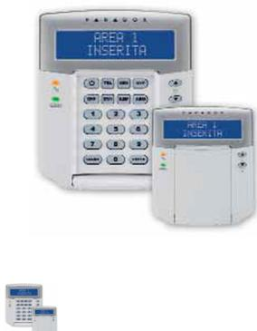
TASTIERA CON VISUALIZZATORE ALFANUMERICO LCD CON RETROILLUMINAZIONE COLORE BLU AD ALTA VISIBILIT', 2 RIGHE DI 16 CARATTERI CON SCRITTE PROGRAMMABILI, SPORTELLINO VERTICALE DI PROTEZIONE DEI TASTI, POSSIBILIT' DI REGOLAZIONE DELLA LUMINOSIT', DEL CONTRASTO E DELLA VELOCIT' DI SCORRIMENTO DEL TESTO. COLLEGAMENTO SU BUS (MAX. 15 TASTIERE). 1 INGRESSO DI ZONA. COMPATIBILE CON CENTRALI SP4000 E SP65 VERSIONE 4.90 O SUPERIORE E CENTRALI MAGELLAN MG5000/MG5050.
