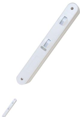
Rilevatore universale a tenda filare bianco , doppio infrarosso, anti mascheramento ad IR attivi, copertura 5m ad un'altezza di 4m, alimentazione 9~15Vdc, assorbimento 12 mA, IP55, Grado 2
