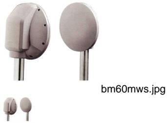
DESCRIZIONE PRODOTTOBarriera a microonde attiva per protezioni perimetrali da esterno e interno, portata massima 60mt, trasmissione segnali allarme, batteria bassa, supervisione, interferenza, via radio 868 MHz, compatibile con SATWS, INTWS, INT4WS, disponibile in 5 canali diversi selezionabili con dip switch, completa di alimentatore 200Vac, 12Vdc, alloggiamento per batteria da 12Vdc 0,8Ah
