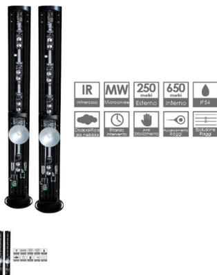
Barriere a doppia tecnologia (MW+IR) per interno/esterno; Portata 650 metri (interno) / 250 metri (esterno); Altezza 2,0 m.; 4Tx + 4Rx. Allineamento con tecnologia SMA. Sincronizzazione filare o ottica. Funzioni Accecamento raggi con uscita OC dedicata, funzione antistrisciamento settabile sul primo raggio in basso, funzione ritardo di intervento, esclusione raggi, Uscita seriale RS-485. Grado di protezione IP54
