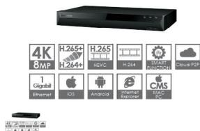
Network Video Recorder standalone 4 Canali; Gestione di 4 telecamere ad una risoluzione massima 4MP (Playback simultaneo di 4 telecamere IP 4MP); 1 Uscita VGA , 1 uscita HDMI; Compressione di registrazione H.265/H.264; 40 Mbps in registrazione; Pentaplex; 1 Uscita Audio; 4 Ingressi / 1 Uscita Allarme; Alloggio per 1 HDD Sata; 1 Porta E-Sata; Ethernet 10/100/1000 Mbps ; CMS per la gestione di piu' NVR, Applicativo per Mobile (iPhone, iPad e Android).
