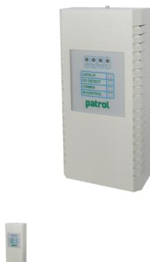
Rivelatore di GPL per uso domestico. Tecnologia microprocessore. Rivelazione basata su utilizzo di sensori catalitici. Alimentazione 12-24 Vdc, Assorbimento 150mA, Grado di protezione IP42. Dimensioni 75 x 155 x 42 mm. Conformi norme EN50194 e EN50291
