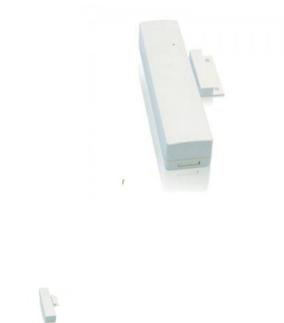
MEGAN dispone di due ingressi indipendenti, un contatto reed e un ingresso NC bilanciato con resistenza di fine linea da 8,2k' per il collegamento di contatti magnetici esterni. L'esclusivo protocollo radio garantisce in ogni condizione la massima sicurezza di comunicazione, ogni segnale trasmesso viene confermato dalla centrale.
