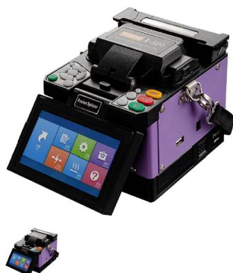
Giuntatrice a fusione per fibre ottiche SM e MM. Allineamento automatico (core-core) con tecnologia digitale PAS e 4 motori. Interfaccia di comunicazione USB. Include menù in italiano, taglierina, spellafibra, elettrodi ricambio, trousse accessori per manutenzione, valigia rigida per trasporto.
