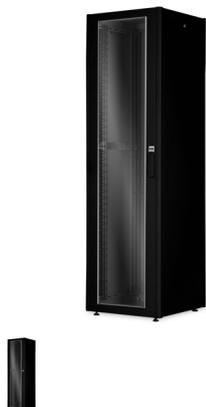
Armadio da pavimento rack 19" 24 unita' smontato, dimensioni L600xP600xH1300 mm. Capacita': 500 Kg, basta una semplice chiave per montare e smontare Rack Floor Pro. Spessore delle lamiere della struttura portante da 2 mm, spessore delle lamiere delle pannellature 1,2 mm. Porta frontale in vetro temperato facilmente smontabile, reversibile e con apertura a 180°. Maniglia frontale 'ad un quarto di giro' con serratura a chiave. Quattro montanti 19" regolabili in profondita'.
