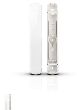
OPX-1 è un contenitore ermetico per installazione in superficie, progettato sia per uso in interno che per uso esterno. Per la sua produzione è utilizzata la tecnologia ad iniezione bi-componente. Attraverso la combinazione di polycarbonato e di materiale sigillante viene ottenuta un'elevata resistenza meccanica e una resistenza ai raggi UV, ma anche la protezione contro agenti atmosferici. Il contenitore è compatibile con il rilevatore AXD-200 e XD-2.
