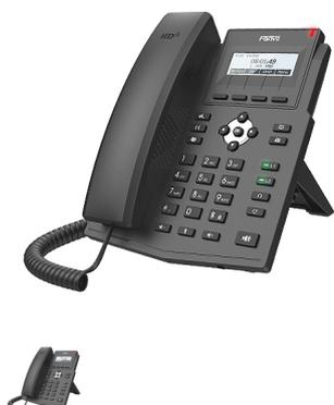
Il telefono Fanvil X1S ' un prodotto entry-level, dotato di tutte le funzionalit' fondamentali per un telefono IP. E' un prodotto compatibile standard SIP con due account configurabili, alimentazione 5V, NO PoE, display LCD dot-matrix, ingresso RJ9 per cuffie e doppia porta di rete 10/100 Mbps
