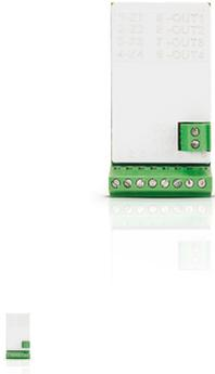
Espansione in miniatura wireless di ingressi e uscite per aggiungere dispositivi filari al sistema ABAX. 4 ingressi programmabili - supporto per rilevatori filari in configurazioni NO, NC, EOL, 2EOL / NO e 2EOL / NC. 4 uscite di tipo OC programmabili. Configurazione e aggiornamento del firmware via radio. Dimensioni 21 x 41 x 13 mm. Alimentazione 4-24 Vdc. Compatibile con sistema ABAX.
